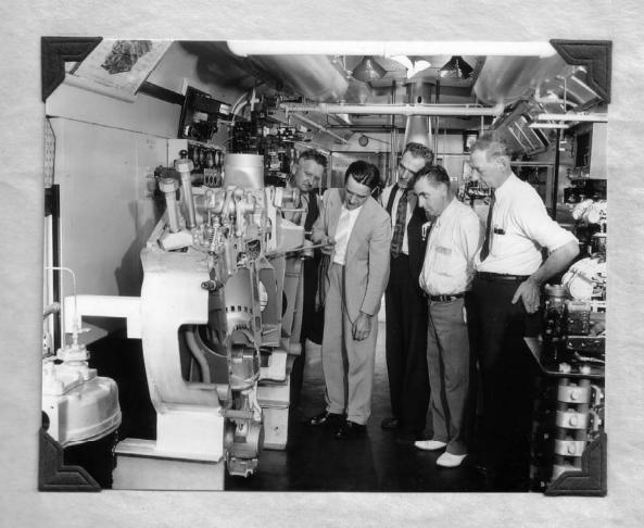
INSTRUCTOR F. B. RYKOSKEY EXPLAINING THE OPERATION OF A TYPE 567 DIESEL ENGINE TO A CLASS
